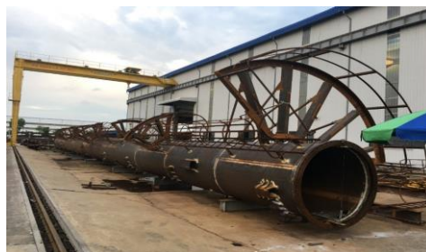
化学プラント用フレアスタック
